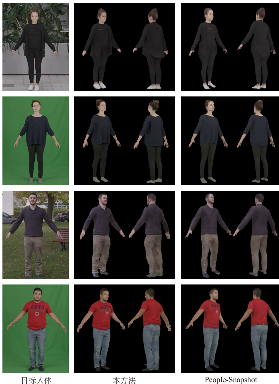
图 3-6 单目视频上的新视角合成效果。与 People-Snapshot [131] 相比，本方法可以渲染出更多的外观细节，如图中第一个人的衬衫和第二个人的裤子。
